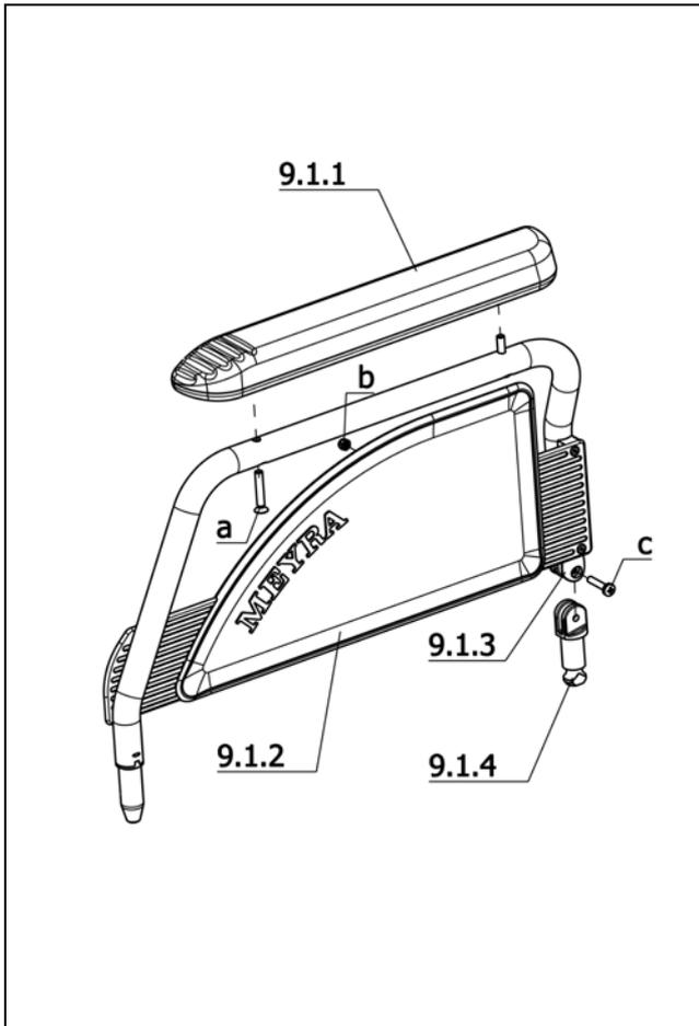
U-Bg.: Code 70; Seitenteil lang, abschwenkbar, abnehmbar
