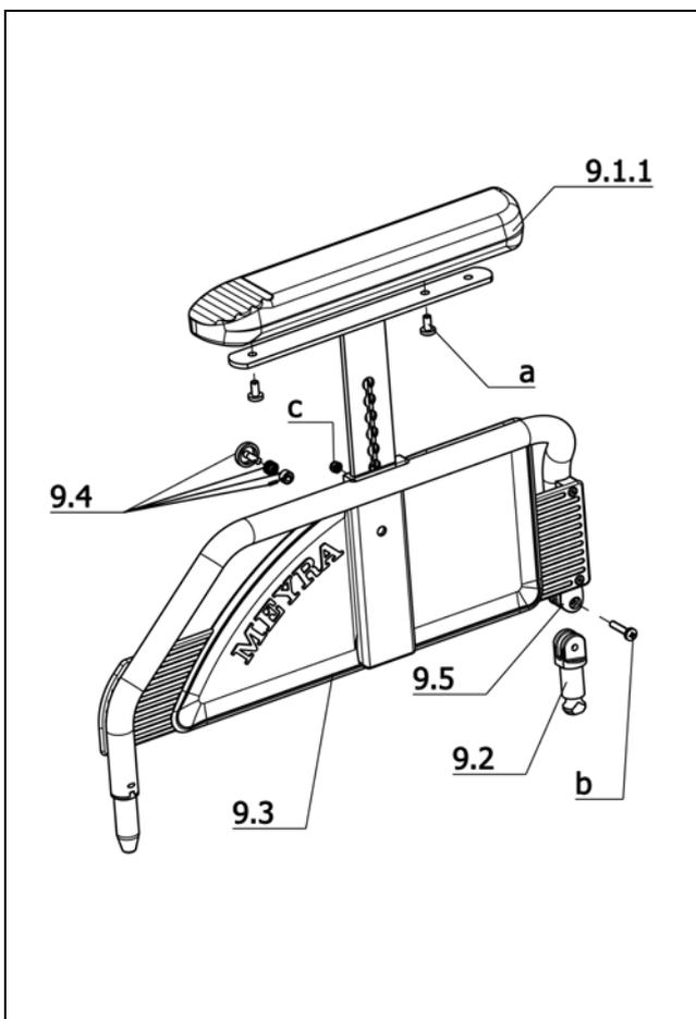
U-Bg.: Code 107; Seitenteil abschwenkbar, höhenverstellbar, abnehmbar
