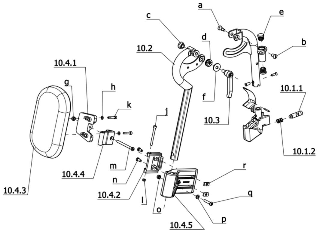
**U-Bg.: Code 92; abnehmbare höhenverstellbare Beinstütze, abschwenkbar**
