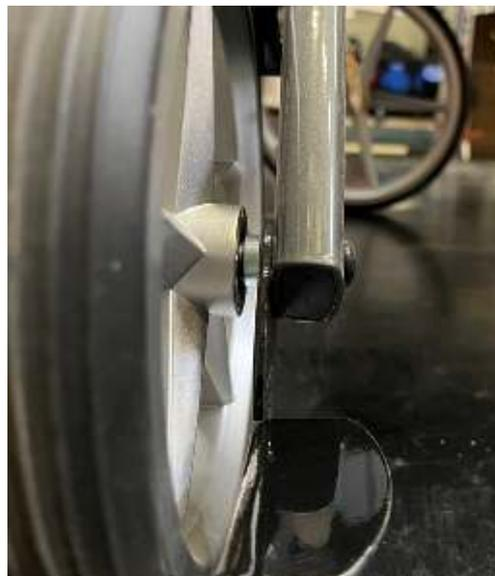
Ziehen Sie die Mutter des Hinterrads mit einem **Drehmoment von 5 Nm** an.
