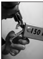
De veiligheidshaak is eenvoudig te openen door de pin met twee vingers naar achteren te trekken.
