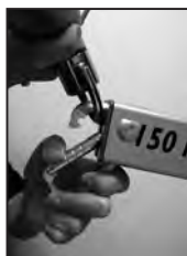
Enkel åpning av karbinkrok ved å skyve sikkerhetslåsen bakover med en finger og hekte på plass løftebøylen.
