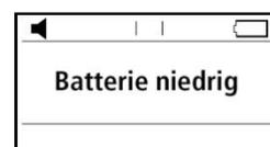
die Batterieenergie nahezu aufgebraucht ist, zeigt der Display die Meldung "Niedriger Batteriestatus" an und blinkt.
